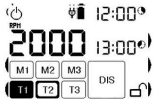
Une fois écoulé l'intervalle de temps de 5 minutes pendant lequel le PrimerCube n'a pas été actif, l'appareil passe en mode STANDBY, c'est-à-dire en mode veille. Dans ce mode d'arrêt, la batterie interne peut être maintenue complètement chargée pendant environ 1 mois. Les programmes prédéfinis sont enregistrés dans la mémoire de l'appareil (mémoire EEPROM), et ne dépendent pas du niveau de charge de la batterie.
