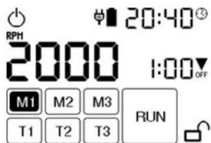
Appuyez sur la touche M1 sur l'écran. Utilisez ce bouton pour régler le temps d'application n°1. Appuyez ensuite sur le bouton indiquant le temps d'application (à droite au milieu de la flèche du temps d'affichage OFF) et l'écran avec les options numériques apparaît :
