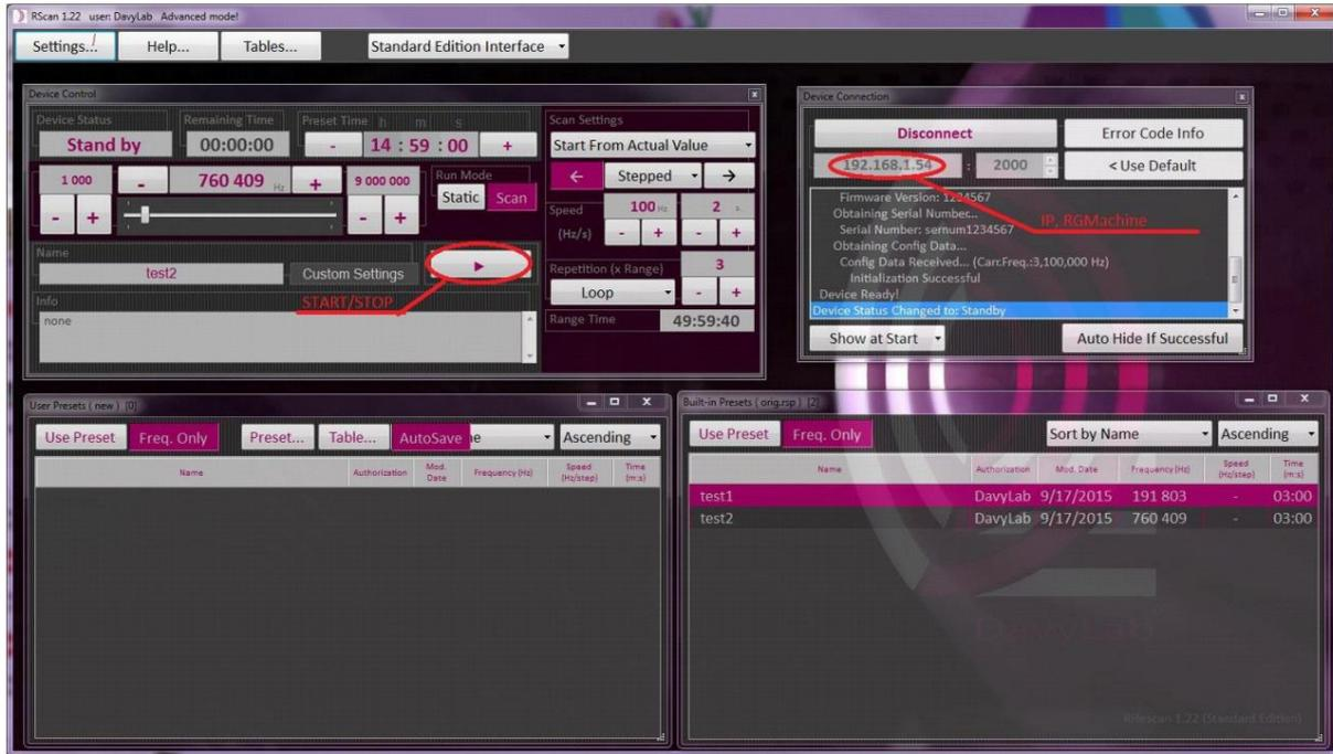
L'appareil peut être contrôlé à l'aide du programme de contrôle. Ce programme est installé sur l'ordinateur connecté et démarre automatiquement avec le système.
